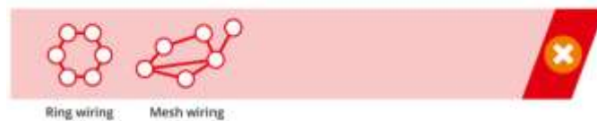
Figura 4. Cableado de bus DALI
