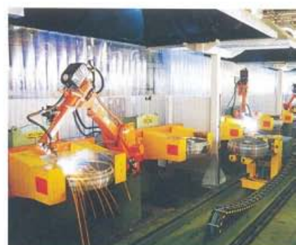
Línea de soldadura automática
