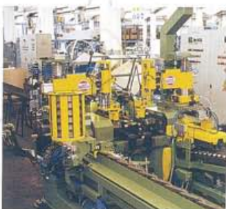
Línea de ensamble automatico de cadenas
