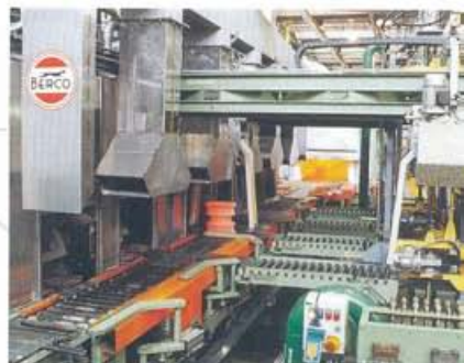
Templado en profundidad de rodillos
